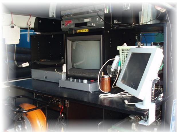
人が入れない管路の中に挿入し、カメラ自走車をオペ室にて操作し管内の情報を調査・収集します。収集した情報は後日報告書として提出します。
